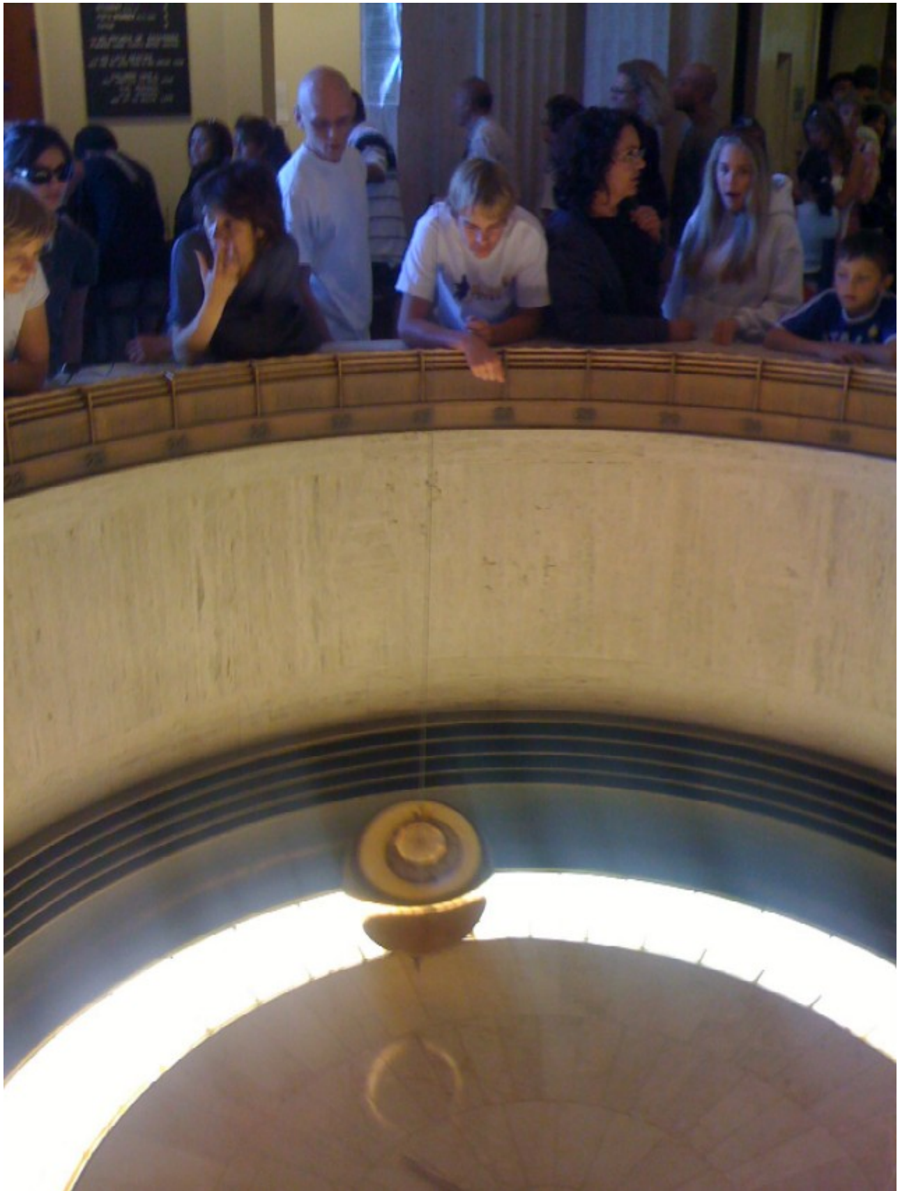
17) Hier in der Eintrittshalle schwingt das goldene Pendel unentwegt und demonstriert, dass die Erde sich wirklich dreht.
