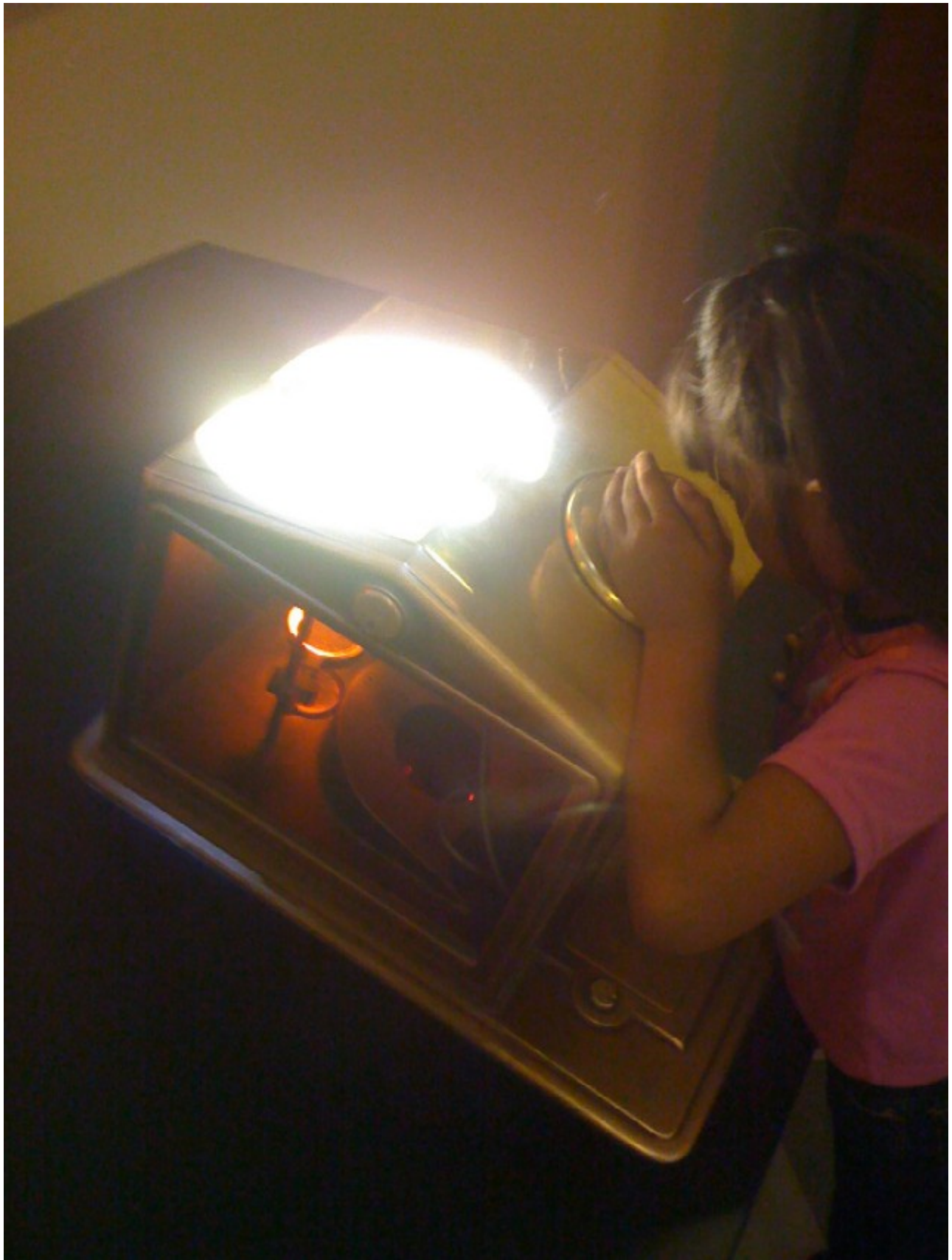
(16) Einer der drei Sonnenstrahlen wird hier auf den H-Alpha Filter gelenkt. Mittels eines festmontierten Okulares kann dann die rote Sonne begutachtet werden.
